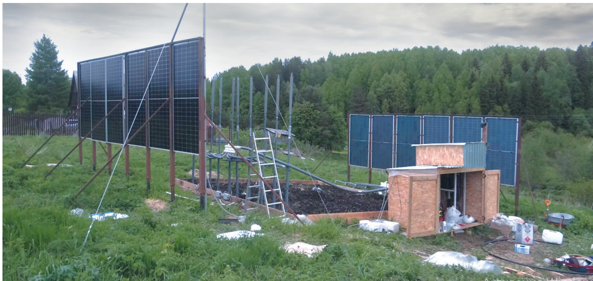
Рис. 5. Общий вид прототипа системы термостабилизации дорожной насыпи автозимника. Составлено авторами Fig. 5. General view of the prototype system for thermal stabilization of the winter road embankment. Compiled by the authors
